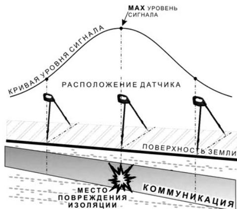
Метод «МАХ» позволяет определить наличие повреждения, однако обладает невысокой точностью локализации места. Причина состоит в том, что кривая изменения уровня сигнала имеет плавный максимум.
