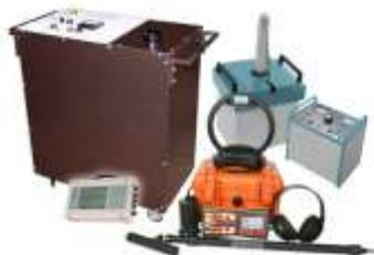
С функцией испытаний кабельных линий.
